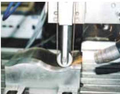
Das Bandschleifen ermöglicht die Herstellung hoher Oberflächengüten bei gleichzeitig hohen Abtragsleistungen.
