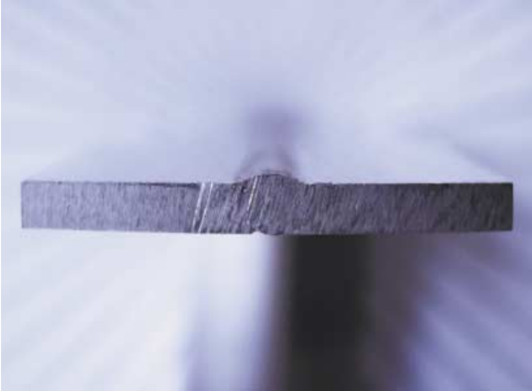
Der Schnitt durch eine Laserschweißnaht auf einem 3 mm dicken Blech aus Aluminium offenbart die Form der Nahtoberfläche.
