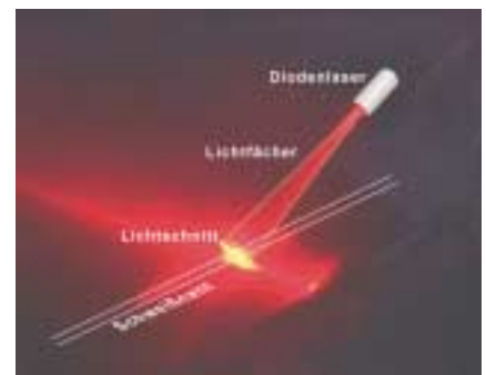
Auf der Schweißnaht wird mit einem Diodenlaser ein Lichtschnitt erzeugt.
