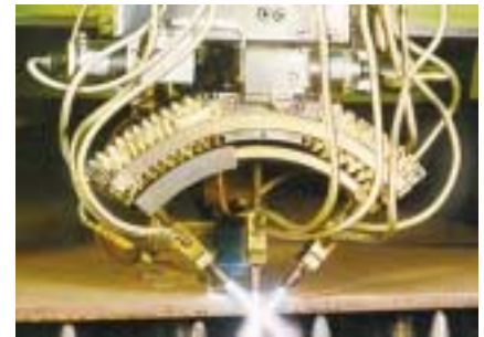
Eine am Unterwassertechnikum Hannover (UWTH) modifizierte Sensorik überwacht einen dreifach Autogenbrenner zur X-Schweißnahtvorbereitung.
