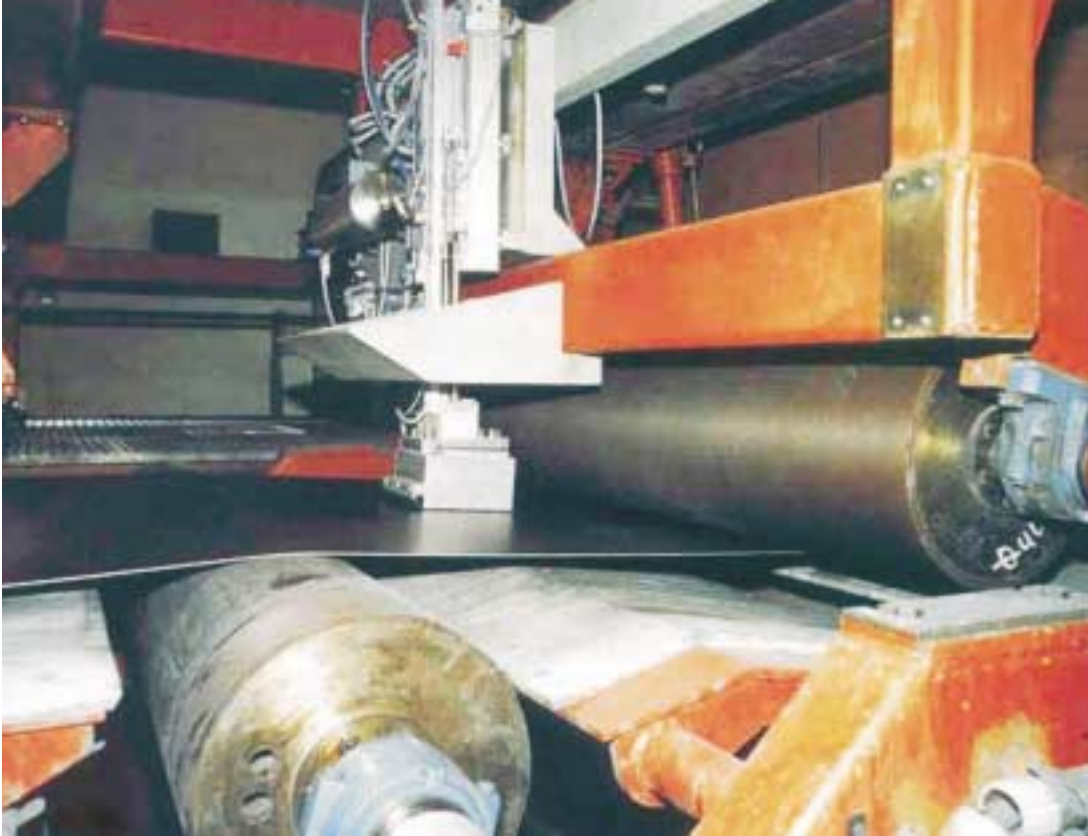
An diesem Inspektions-Coil befindet sich ein harmonisches Messsystem der Universität Hannover im industriellen Einsatz.
