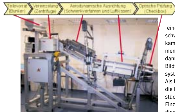
Am IFA wurde ein erster Prototyp eines aerodynamischen Zuführsystems realisiert.
