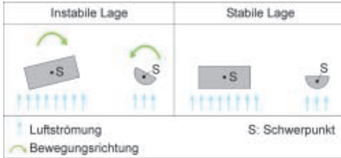
Die Ausrichtung der Werkstücke auf einem Luftkissen.
