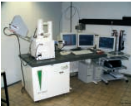
Das Rasterelektronenmikroskop LEO 1455 VP mit Peltier-Kühlung bietet die Möglichkeit, native Proben ohne Artefakte darzustellen.
